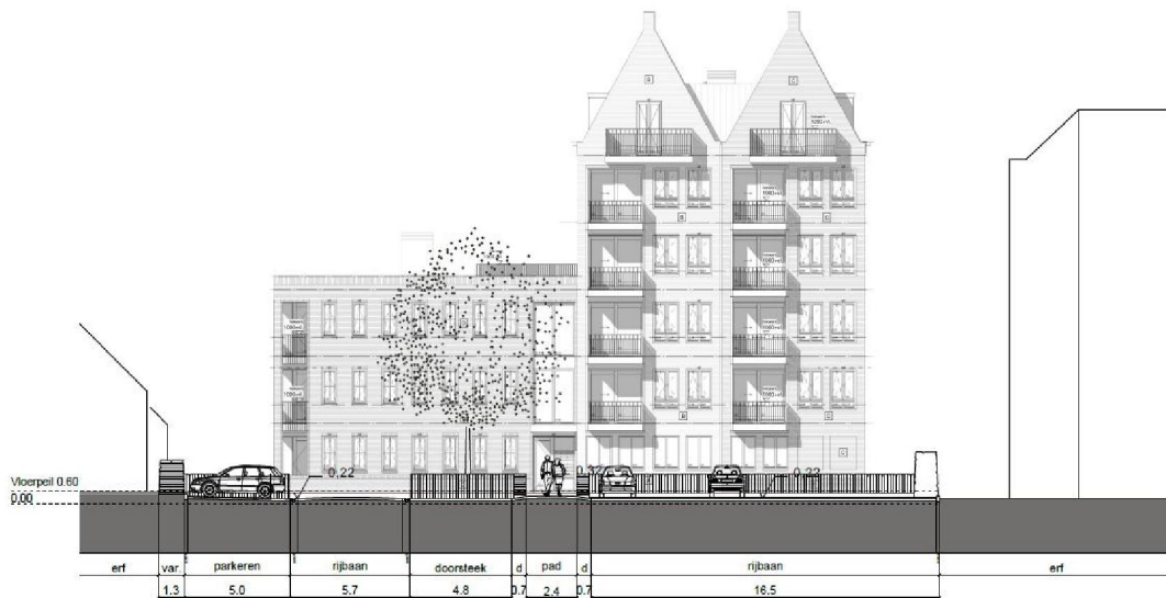
Figuur 2.5 Doorsnede (D) voorzijde appartementencomplex Oudelandseweg 44
